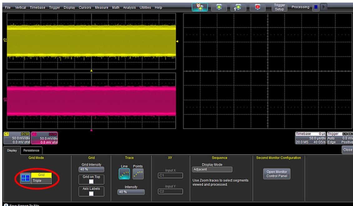
3. ズームの設定をし、CH1,CH2の波形の確認が出来るように設定します。LBPが出力されているかを確認します。
