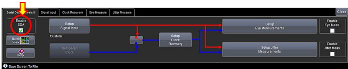
6. Signal Inputタブで入力の設定を行います。①Input1-Input2を選択。②Input1にC1, Input2にC2を設定します。
