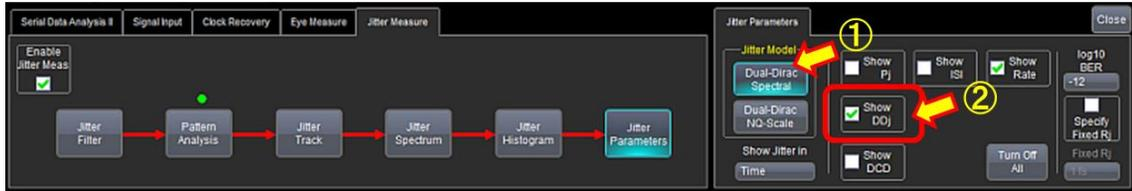
12. Eye Height、Eye Width、DDJの各パラメータの測定結果が表示されるので、Reference 情報として記録します。
