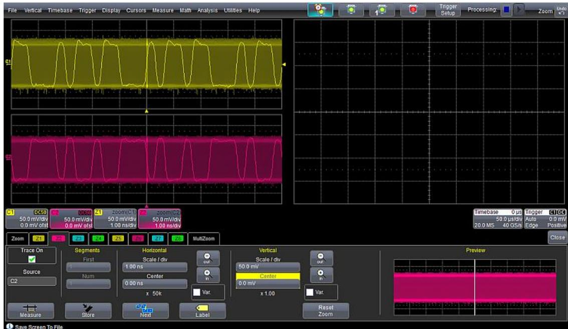
4. オシロスコープの測定ソフトウェア (SDA II) を起動します。オシロスコープのメニューバー -> **Analysis -> Serial Data...** から、SDA IIソフトウェアを起動します。
