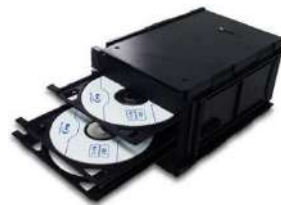
(b) RFID タグ内蔵 35 枚入りマガジン
